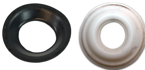
Centrale schijf uitgescheurd
