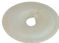
Geïmplodeerde persluchtzijde Slijtagesporen persluchtzijde
